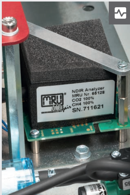
NDIR-Küvette für \text{CH}_4/\text{CO}_2 -Analyse, für Biogas- und Deponiegasmessungen
