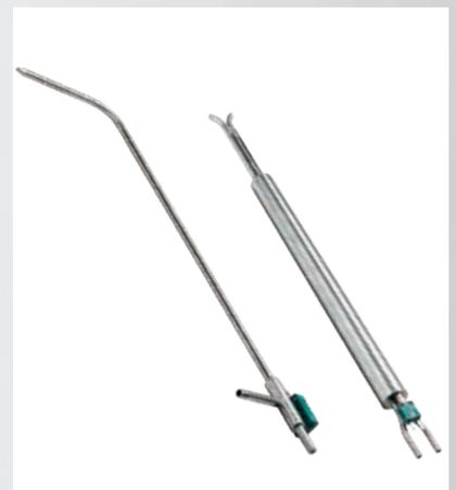
Strömungsgeschwindigkeitsmessung (m/s) mit Staurohren
