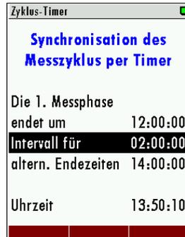
*Im abgebildeten Beispiel wird die Messphase stets um 12 Uhr, 14 Uhr, 16 Uhr, 18 Uhr, 20 Uhr, 22 Uhr, 0 Uhr, 2 Uhr, 4 Uhr, 6 Uhr, 8 Uhr oder 10 Uhr beendet. Das bedeutet, dass die Nullpunktnahmen (außer die erste nach Power-On) stets um diese Zeiten gestartet wird.*
