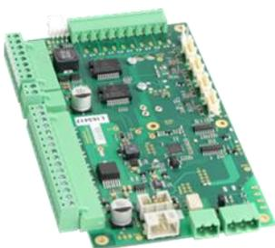
Sie finden den Alarm-Relais Anschluss und den RS-485 Anschluss am Mainboard.
