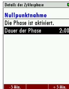
Im Menü können die Details der Zyklusphase für die Nullpunktnahme angeschaut und ggf. geändert werden.
