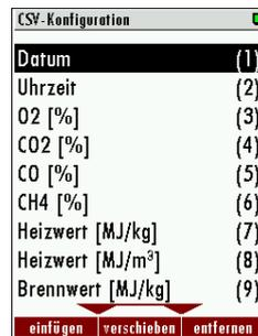
▶ Bearbeiten Sie die CSV Konfiguration. Nutzen Sie dazu die **Funktionstasten F1 F2 F3** zum einfügen, verschieben oder entfernen von CSV Werten.
