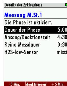
In den Details für die Zyklusphase kann die Messzeit und die Ansaugzeit geändert werden. Jede einzelne Messstelle kann individuell angeglichen werden.
