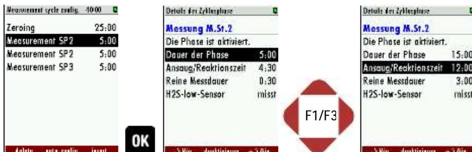
5. Das Detailmenü verlassen und zur nächsten Phase im Konfigurationsmenü gehen. Mit der *links/rechts* Taste die Phase „Nullpunktnahme“ auswählen und die Phasendetails öffnen. Hier die Dauer der Phase auf 15:00 min. stellen und das Detailmenü verlassen.
