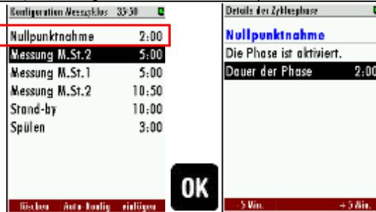
**Messung MSt.x (Zyklusphasendetails):** In den Details für die Zyklusphase kann die Messzeit und die Ansaugzeit geändert werden. Jede einzelne Messstelle kann individuell angeglichen werden.
