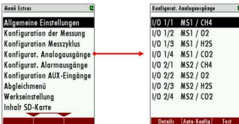
2. Im nächsten Schritt muss der Analogausgang konfiguriert werden. Dafür das Menü: Extras/Konfigur. Analogausgänge öffnen. Es erscheint das Konfigurationsmenü für die Analogausgänge. In der Übersichtsliste muss der erste Analogausgang ausgewählt werden (Kanal: I/O 1/1 MS1 / CH4).
