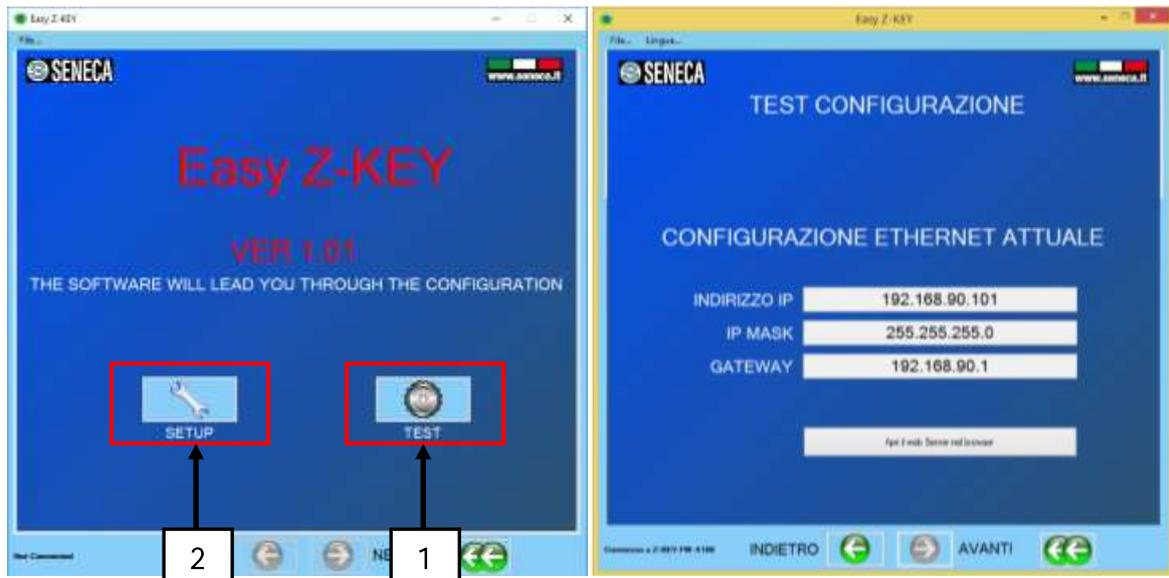
3. In das Hauptmenü zurückgehen und „Setup“ drücken. Das Ethernetmodul, mit Hilfe eines USB-Kabels mit einem PC verbinden. Danach „Automatic search“ (3) drücken.
