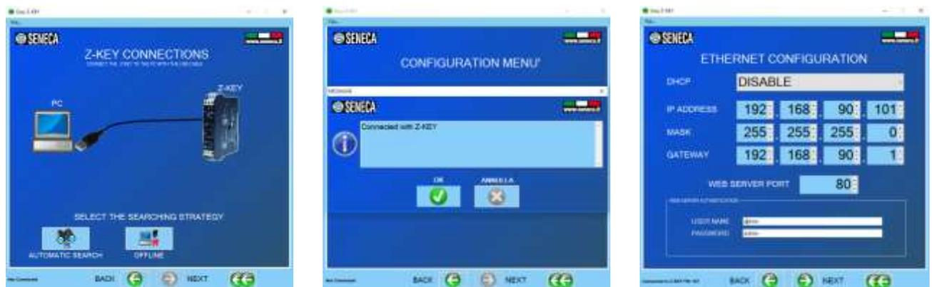
4. In der nächsten Einstellung „Send IP configuration to Z-key“ drücken. Die IP-Adresse, Mask und Gateway kann eingegeben werden.
