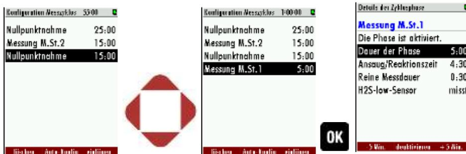
7. Zum Schluss im Konfigurationsmenü eine neue Phase erstellen. Dazu F3 drücken und mit den links/rechts Tasten die Phase „Ruhemodus“ auswählen. Im Detailmenü die Spülzeit auf 3 min., die Ruhezeit auf 10 min. stellen.
