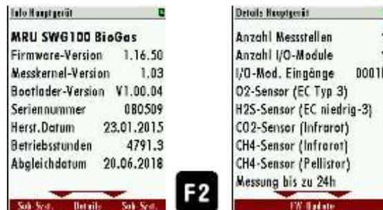
2. **F2 = Details** öffnen. Es werden die Details und Parameter des Analysators angezeigt.
