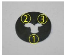
Achten Sie beim Einsetzen der Dichtungsscheibe auf die Bohrungen.
