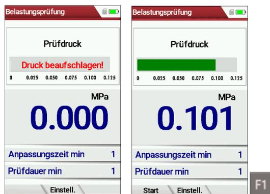
In diesem Fenster wird der zu prüfende Leitungsabschnitt mit dem Prüfdruck beaufschlagt.
