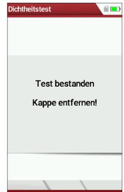
Falls die Dichtheitsprüfung nicht bestanden wurde müssen Sie die Sonde inklusive der Verschlauchung sowie der Kondensatabscheider überprüfen.
