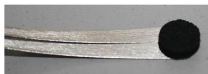
Dieser Oberflächentemperaturfühler ist für die Messung an schlecht zugänglichen Messstellen geeignet.
