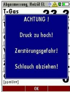
Bei zu hohem Druck wird folgende Fehlermeldung angezeigt:
