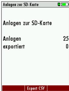
Mit dieser Funktion kann das Messgerät seinen Anlagenstamm sichern (Backup) oder einem PC oder einem anderen Messgerät zur Verfügung stellen. Das macht z.B. Sinn, wenn die Anlagendaten im Messgerät manuell geändert wurden – z.B. aktualisierte Telefonnummer – und diese Änderungen beim PC-Programm ein gepflegt werden sollen. Oder wenn ein zweites Gerät mit demselben Anlagenstamm versehen werden soll.
