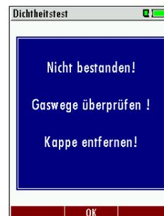
Falls der Dichtheitsprüfung nicht bestanden wird muss die Sonde inklusive der Verschlauchung sowie der Kondensatabscheider überprüft werden.
